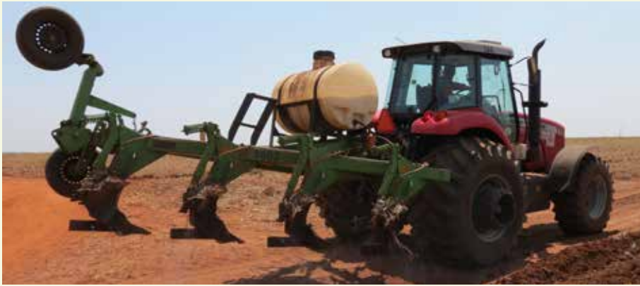
Arado de aiveca utilizado na operação de barreira química que antecede o sulco de plantio
