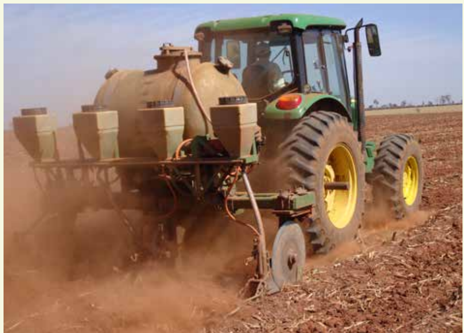
Nas áreas de cana soca (pós-colheita), o inseticida escolhido deve ser aplicado com implemento específico, que injeta 100% da calda na linha da cana-de-açúcar
