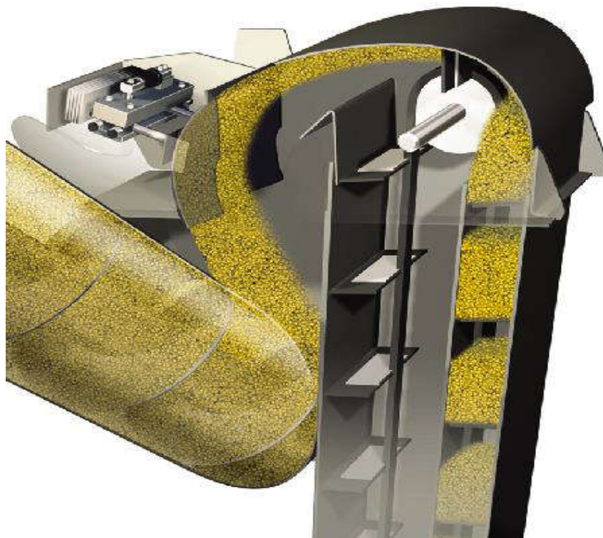
Figura 13. Sistema de condução do grão para o graneleiro. Fonte: Nunes, 2016.
