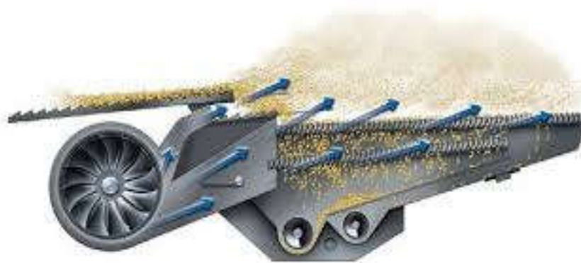
Figura 12. Sistema de limpeza dos grãos. Fonte: Nunes, 2016.
