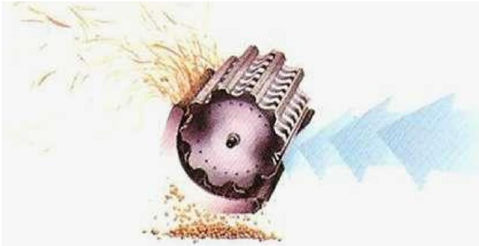
Figura 8: Cilindro e Côncavo de Fluxo Transversal.
